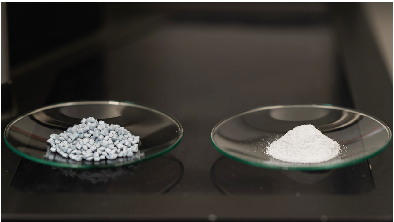
Imagen 1: Muestra de plástico antes y después de la molienda con el molino de rotor de alta velocidad PULVERISETTE 14 premium line
