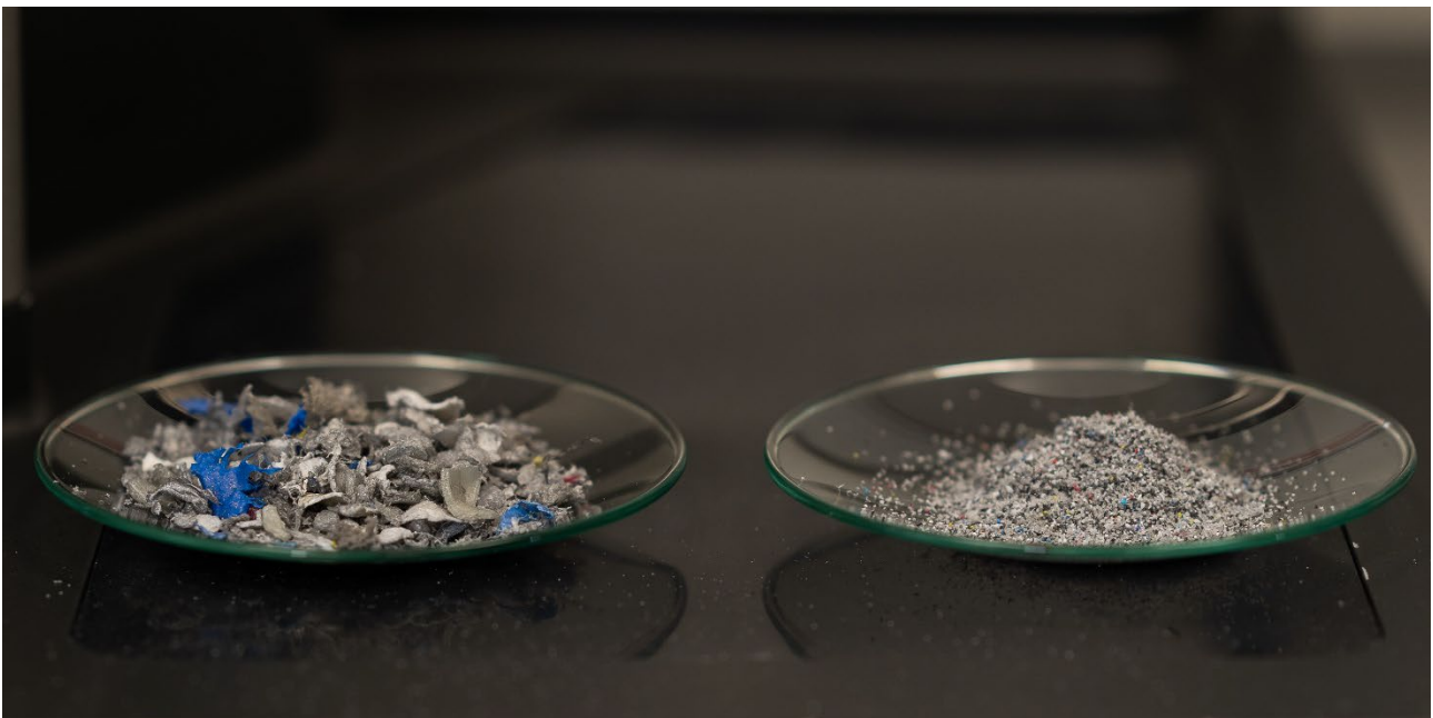
Imagen 2: Muestra de plástico antes y después de la molienda
