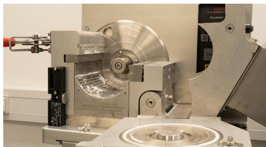
Imagen 2: Cámara de molienda P19 LARGE después trituración
