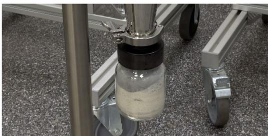
Imagen 3: Descarga de la muestra en el recipiente de vidrio ciclónico
