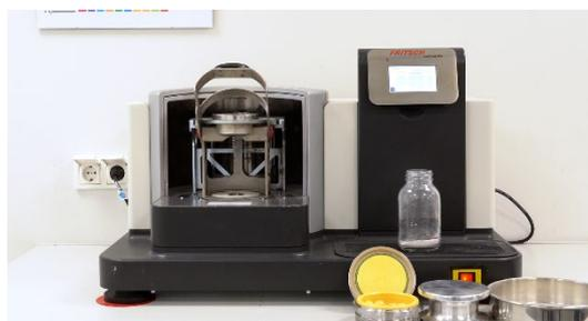
Imagen 6: PULVERISETTE 5 *premium line* con accesorios ZrO<sub>2</sub>
