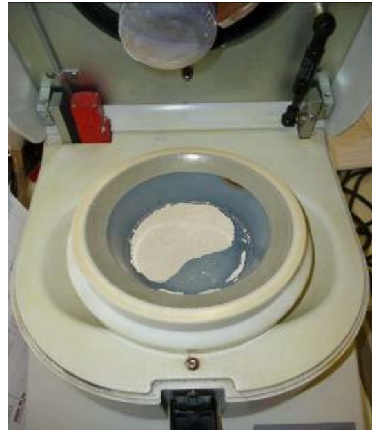
Imagen 2: 20 g de arena molido con el P-2 mortero de ágata después de 30 minutos
