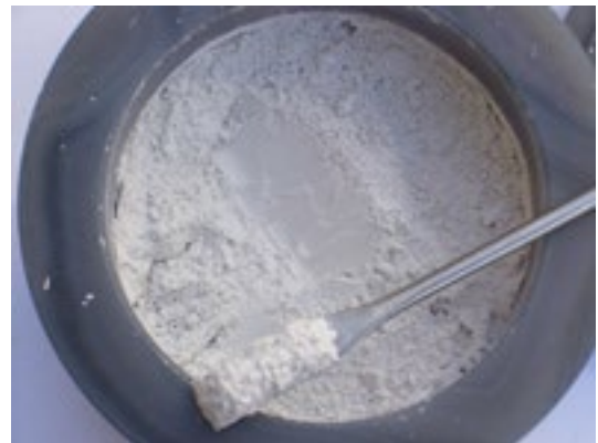
Imagen 3: 100 g arena de cuarzo molido después de 5 minutos con el molino P-6, con vaso 250 ml y bolas 20 mm de ágata
