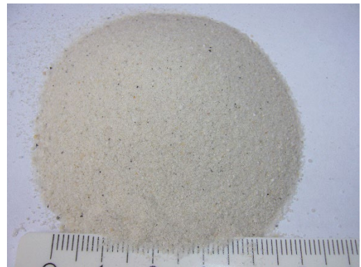
Imagen 1: 20 g de arena como material inicial para una molienda de prueba
