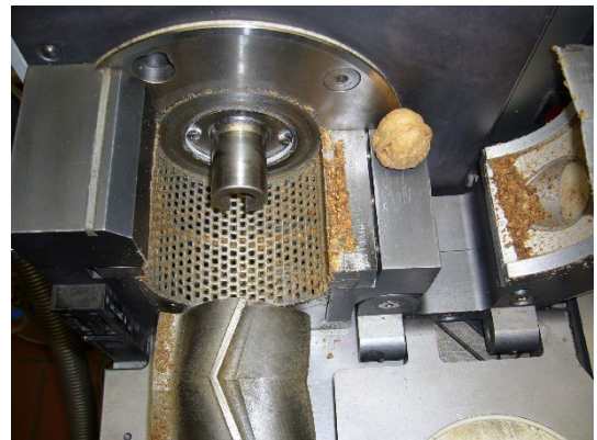
Imagen. 3: Vista de la cámara de molienda abierta muestra un rendimiento óptimo para nueces
