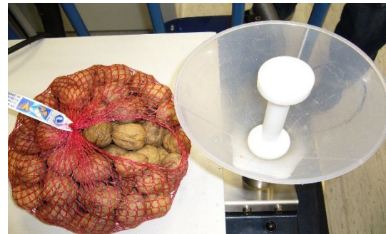
Imagen 1: Las nueces deben prepararse con un molino de corte
