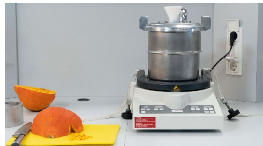
Imagen 1: Calabaza pre-molida & PULVERISETTE 0 con caja criogénica
