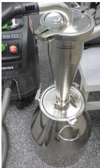
Imagen 3: Ciclón con aspiradora y recipiente de 20 litros
