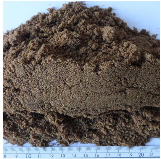
Imagen 4: Resultado homogénea después molienda con bandejas de tamiz con orificios cuadrados.
