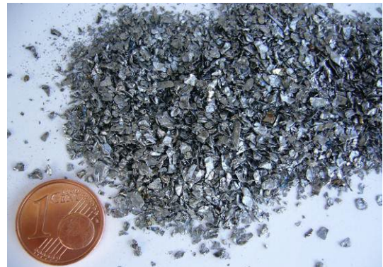
Imagen 3: Molienda con el PULVERISETTE 19 y tamiz de 2 mm
