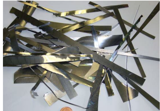
Imagen 2: Vanadio laminado para preparación de muestras
