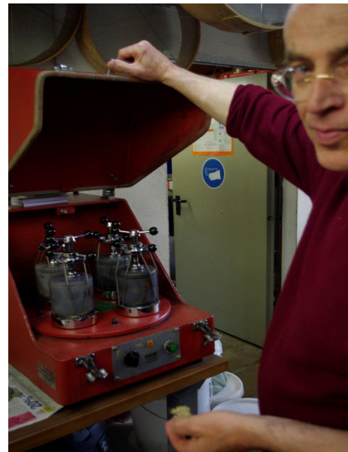
Imagen 3: Dr. Kremer utilizando el molino planetario de bolas PULVERISETTE 5
