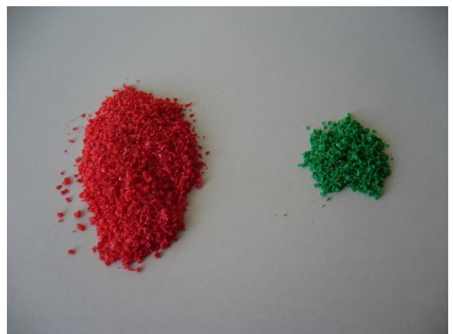
Imagen 3: Pre-tritución con el PULVERISETTE 19, tamiz de 2 mm
