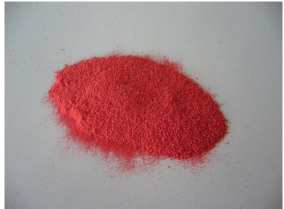
Imagen 4: Finura del análisis tras la molienda con el PULVERISETTE 14 classic line
